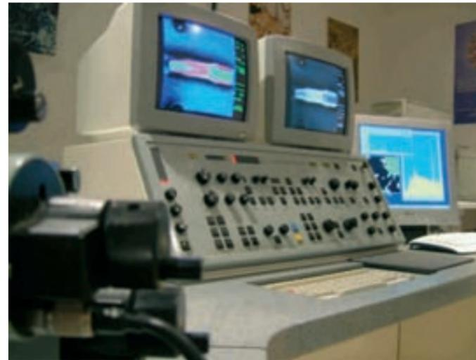
Microscopio Electrónico de Barrido DSM 940A Zeiss con sistema de microanálisis (EDS) Oxford Link ISIS en instalaciones del Servicio de Microscopía Electrónica, Universitat de Lleida
